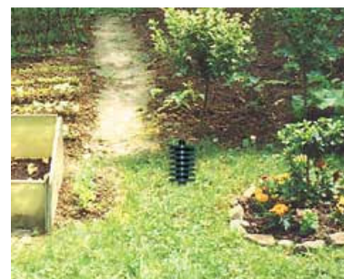
Beamer agricole installé dans le jardin, la tête doit dépasser de la terre
